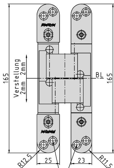
Spanplattenschr.  $\varnothing 4.5$
